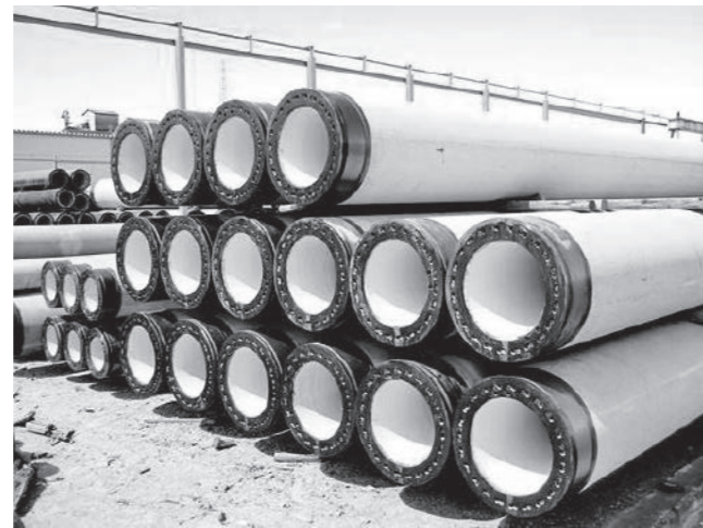
既製コンクリート杭
