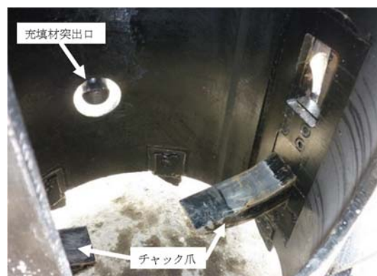
図4 チャック爪の突出
